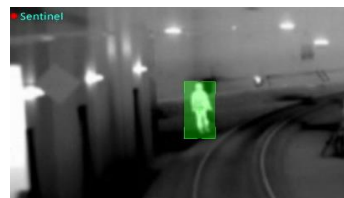
DETECCION DE INTRUSION EN TUNELES
