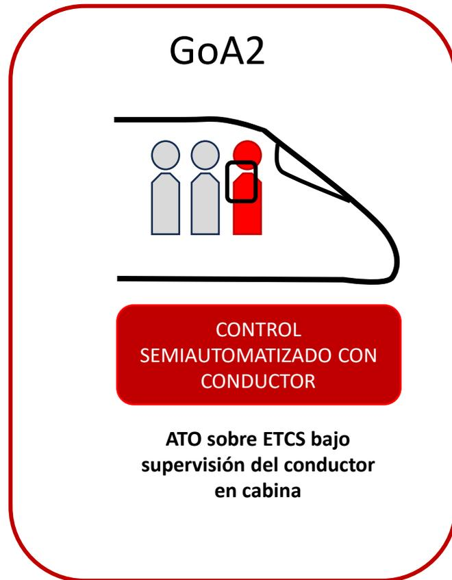
ATO opera bajo la supervisión del ETCS y el principio básico para garantizar la seguridad y proporcionar interoperabilidad integrada en la arquitectura del ERTMS es dividir las responsabilidades entre las partes que intervienen en la operación:
