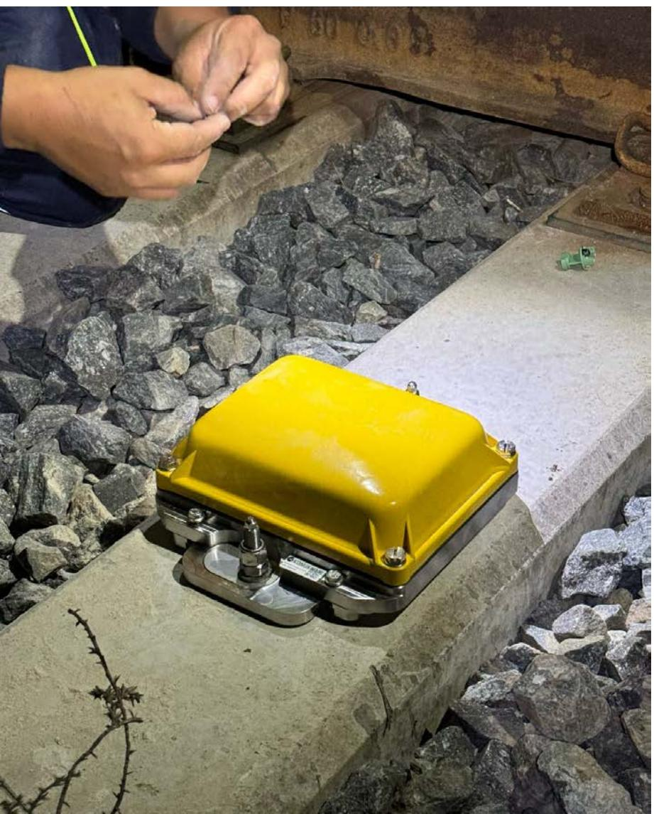
**Sistema de mantenimiento predictivo KONUX Switch** de desvíos que utiliza dispositivos IoT e IA basados en acelerometría para supervisar y analizar de manera continua el estado de los componentes del desvío (accionamiento, corazón, espadín, etc.). Sistema muy poco intrusivo que se instala directamente sobre una traviesa.
